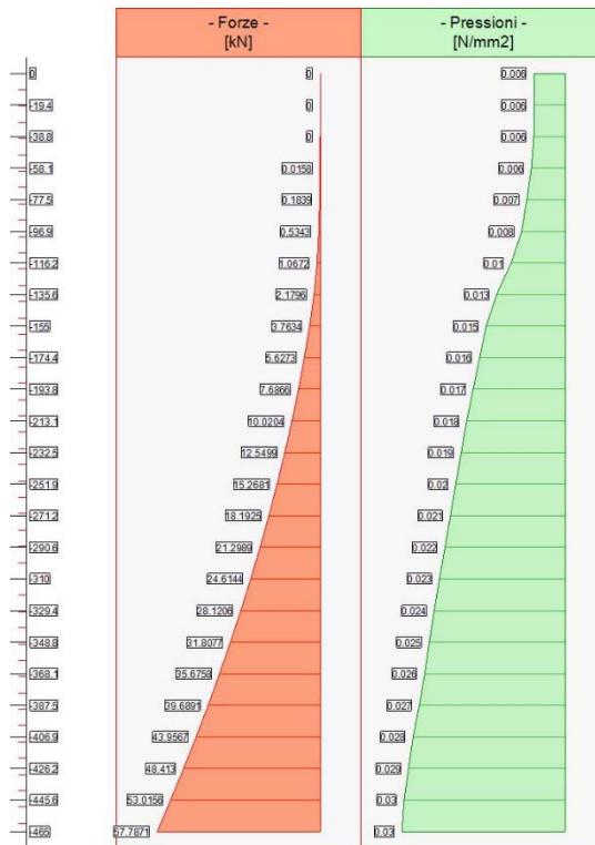
Forze (totali) e Pressioni lungo il fusto, per il Caso 3 ( SLV_SISMA_GIU [ SLV ] - Sisma_1+1+R_Giu )
