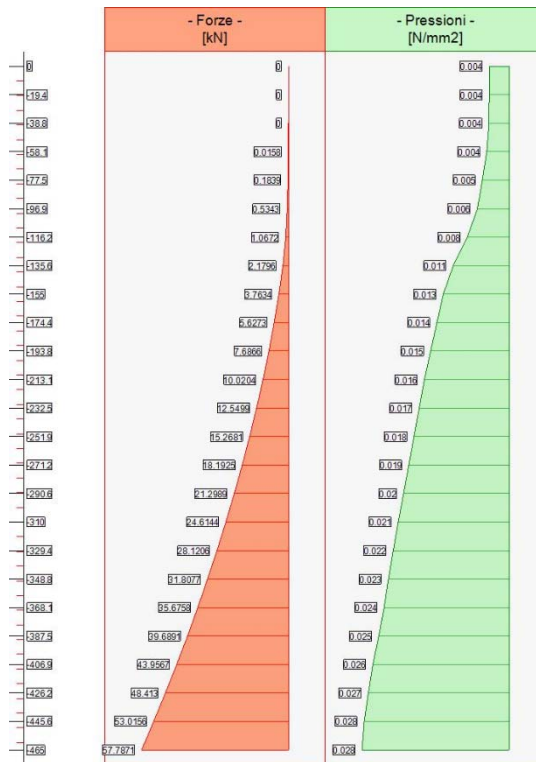
Forze (totali) e Pressioni lungo il fusto, per il Caso 2 ( SLV_SISMA_SU [ SLV ] - Sisma_1+1+R_Su )
