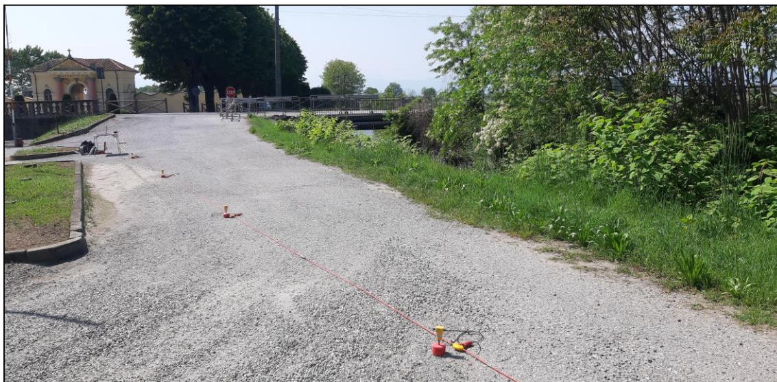
Fig. 6: indagine sismica tipo M.A.S.W. eseguita in destra idrografica del torrente Lemina.
