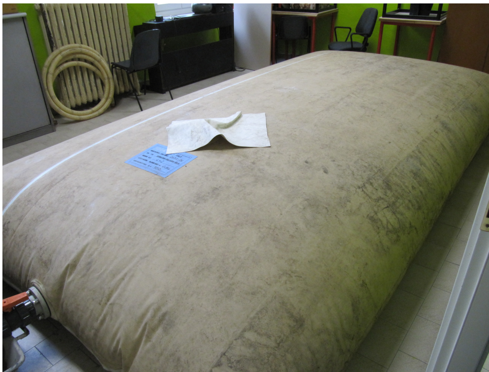
Figura 32 - Prova di carico su solai in putrelle e tavelloni Corpo D
