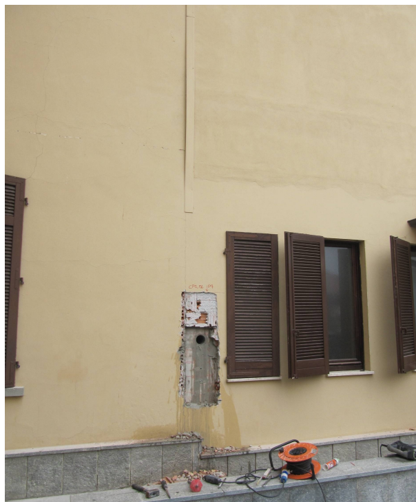
Figura 25 - Estrazione carota CP5 Corpo B
